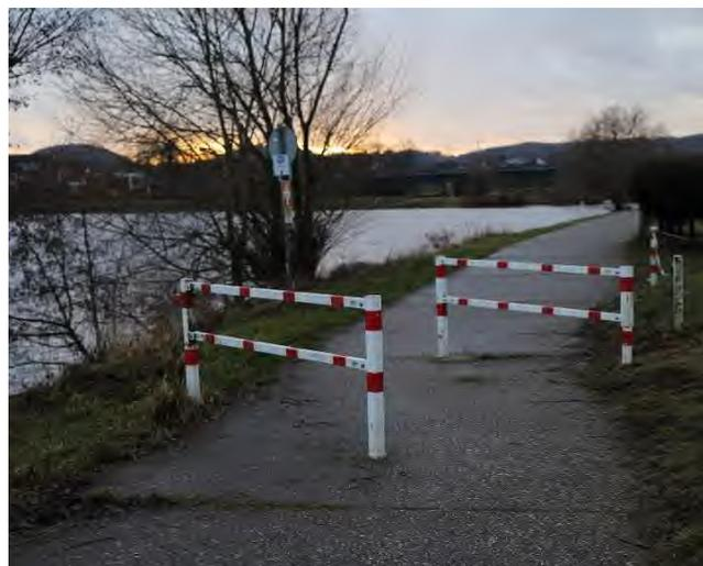
Abbildung: Beispielhafte Umlaufsperrn
