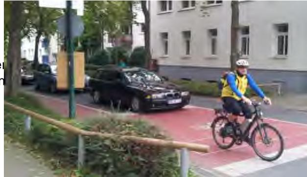
Abbildung: Aufgeweiteter Radaufstellstreifen, Darmstadt
