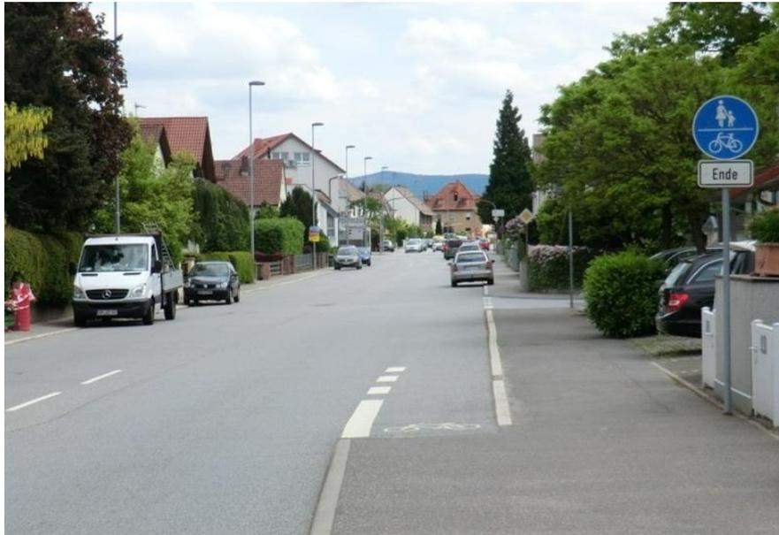
**Abbildung 10: Beispiel einer markierten Ausleitung auf die Fahrbahn (Foto: R+T)**
