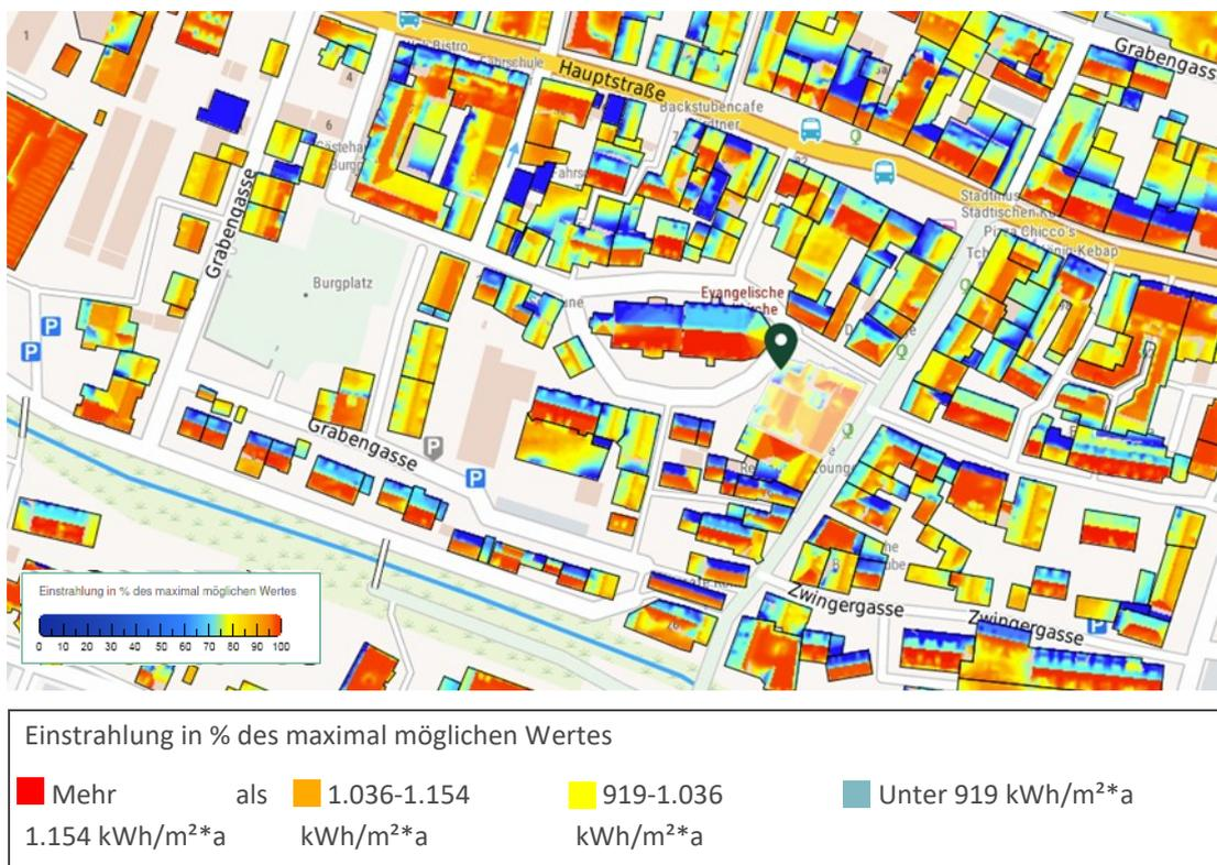
Abbildung 5-5: Ausschnitt aus dem Energieatlas des Landes Baden-Württemberg - Solarpotenzial auf Dachflächen [Energieatlas LUBW]
