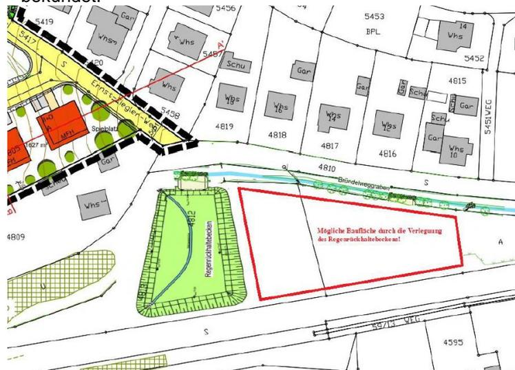
Anlage Skizze verlegtes Regenrückhaltebecken
